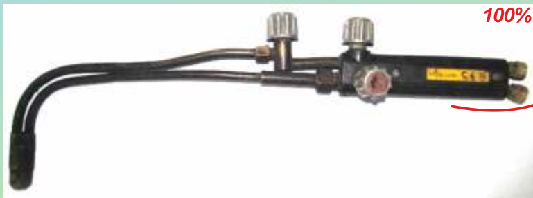
Изношенные мундштуки и головка резака
