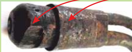
Изношенные мундштуки и головка резака
