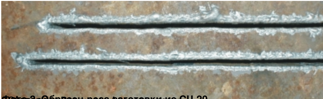
Рис. 2. Образцы после резки из СЧ-20
