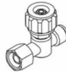
ВЕНТИЛЬ К (до ШВЛ) Вхід: гайка M16x1,5 лінза Вихід: штуцер M16x1,5 (плаский торець) 943.000.29
